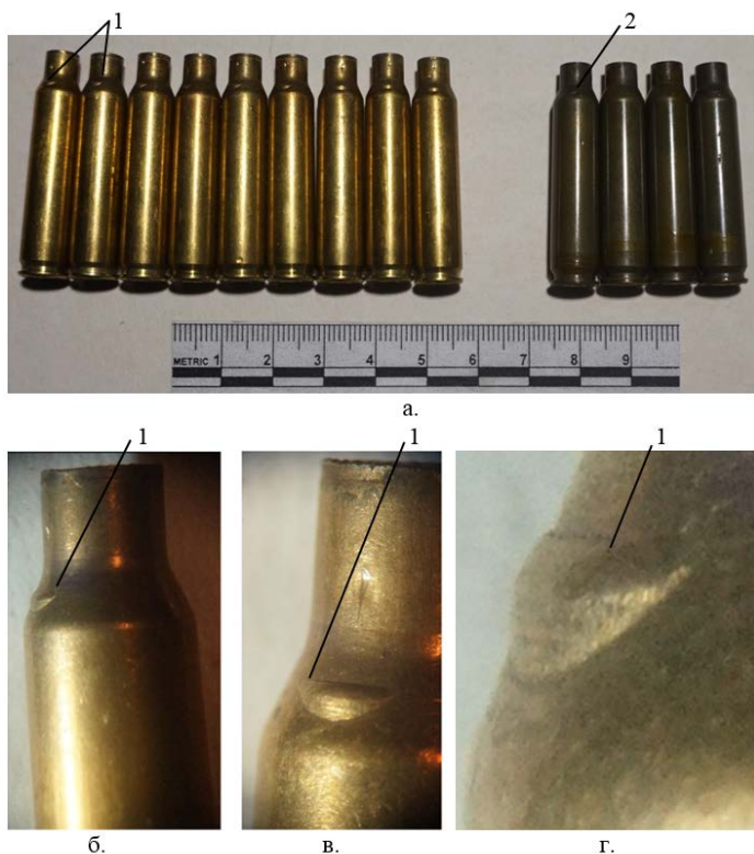
Рис. 5. Образование следа маркера на скате гильзы 5,56 x 45, стреляной из автомата АК-101: 1 – след маркера в виде выступающего полумесяца на скате латунной гильзы; 2 – след маркера на стальной лакированной гильзе.
